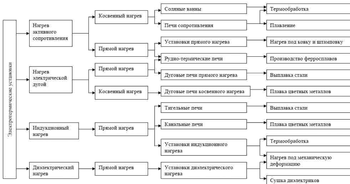
Рис. 1. Классификация электротермических установок по основным, применяемым способам превращения электрической энергии в тепловую энергию
